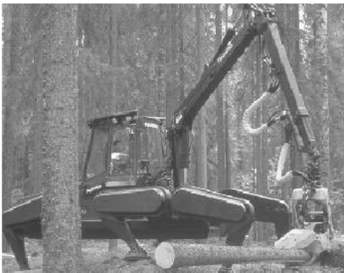
Esempio di robot dal modello descritto sopra con utilizzo in terreno irregolare
