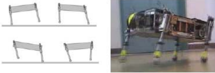
Il modello di andatura saltellante adottato per Scout II e un fermo immagine del robot in movimento
