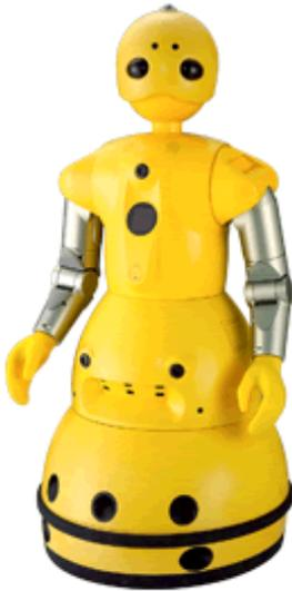
WAKAMARU è alto 1 metro e pesa 27 kg, si muove su ruote ed è alimentato a batterie che è in grado di ricaricare autonomamente quando stanno per esaurirsi.
